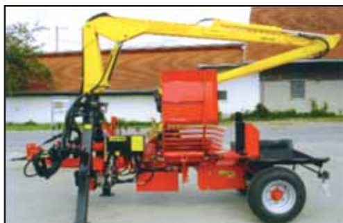
Fendeuse avec grue
