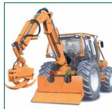
Grue sur tourelle avec treuil à l'avant
