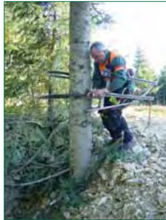
2 Accrochage de la sangle réglable de l'élément du bas en passant autour de l'arbre
