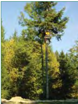
5 Le grimpeur vous permet d'élaguer jusqu'à 15 cm de diamètre de l'arbre
